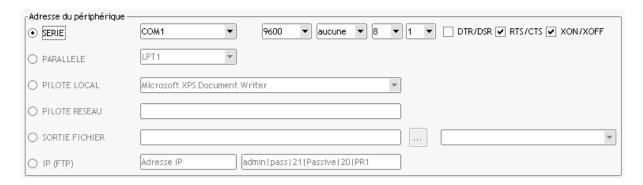
Voici la configuration à respecter pour les quatres sortes de balances, **Mettler Toledo, Testut, Dexal DXN60 et KERN DE 60K1DL,** connectées sur un port série :
